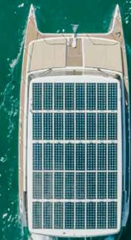
*Sun Concept a lancé la production en série de ses catamarans de 12 mètres de long à propulsion entièrement solaire avec deux moteurs Deep Blue. Le Cat 12.0 se configure à volonté en bateau de plaisance ou pour le transport de 42 passagers.*
