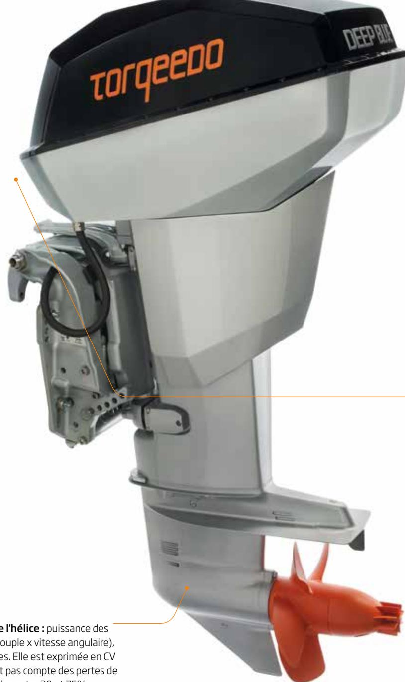
**Puissance à l'arbre de l'hélice** : puissance des hors-bord à essence (couple x vitesse angulaire), comme pour les voitures. Elle est exprimée en CV ou en KW, mais ne tient pas compte des pertes de l'hélice qui peuvent varier entre 20 et 75%.
