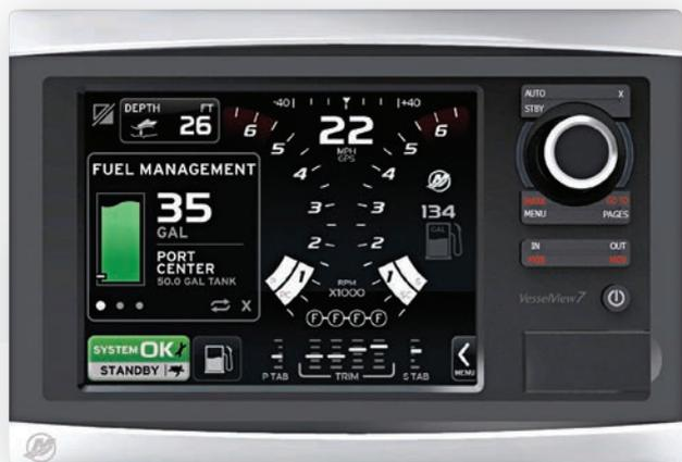
VesselView 7 permet de surveiller jusqu'à quatre moteurs
